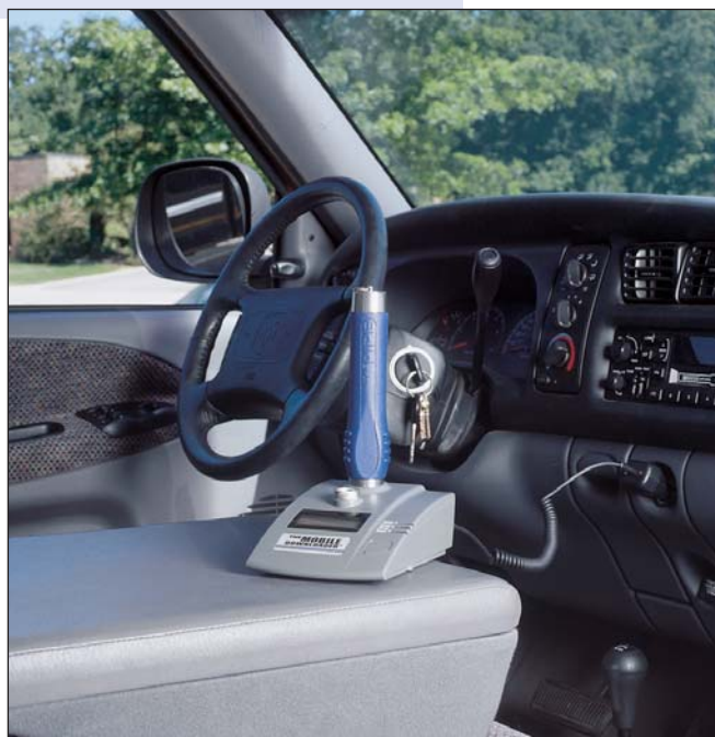
Nutzen Sie die tragbare Transfereinheit, um im Einsatz – ob am Standort selbst oder sogar im Auto – die Daten aus der PIPE zu übertragen.
